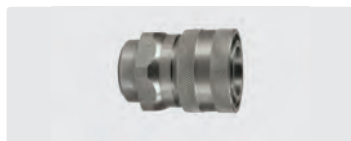
Coupleur femelle : femelle. Inox. Max. 250 bar / 150 °C
