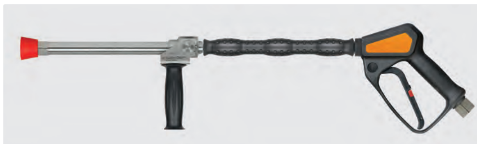
Lance d'hydro-balayage 350 mm inox avec manchon ST-29 Cool & Compact 330 mm, pistolet ST-2320, poignée latérale et protège-buse en PVC, livrée sans buse. Max. 150 bar / 80 l/min / 100 °C
