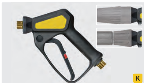
Pistolet professionnel avec raccord de sortie surmoulé adaptable sur lances rotatives. Max. 310 bar / 45 l/min / 150 °C
