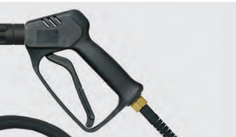
Pistolet professionnel avec manchon 340 mm, max. 210 bar / 25 l/min / 150 °C. Entrée / sortie M22 F. Équipé d'un flexible Flexy avec 1 tresse métallique, max. 300 bar / 100 °C
