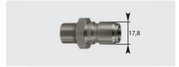
Coupleur mâle : mâle. Inox. Cône 60°. Max. 250 bar / 150 °C
