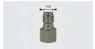
Coupleur mâle : femelle. \varnothing 14,8 mm. Acier zingué. Max. 250 bar / 100 °C
