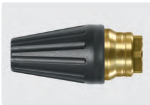
1/4" F. Cône 20°. 200 - 400 bar. Max. 100 °C
