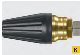
M18 F. Cône 20°. 200 - 400 bar. Max. 100 °C
