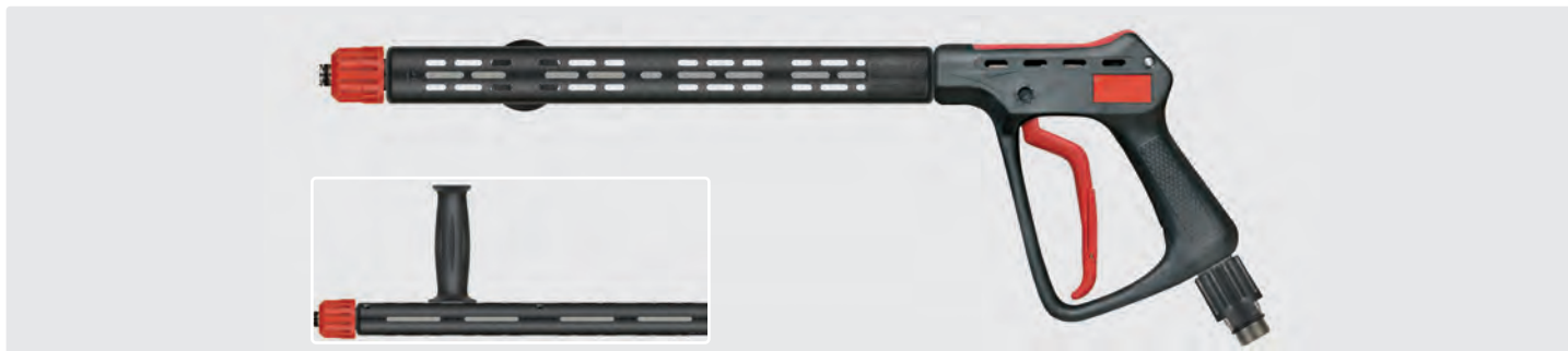
Pistolet THP professionnel avec demi-coquilles ST-9 380 mm, poignée latérale et raccord manuel ST-740. Max. 600 bar / 80 l/min / 150 °C
