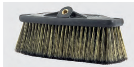
A= 270. B= 260 x 80 mm. Mixte de poils de sanglier et de poils synthétiques. Max. 40 l/min / 60 °C
