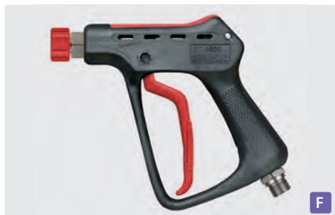
Pistolet THP professionnel avec sortie M22 F. Max. 500 bar / 80 l/min / 150 °C
