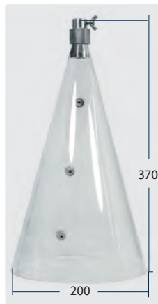
Cône de protection contre les éclaboussures en PVC, avec support en acier inoxydable, fixation réglable sur le tube de lance avec vis papillon. Max. 80° C
