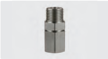
1/2" M : 1/2" F. Inox. Max. 350 bar / 90 °C
