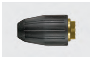
1/4" F. Cône 20°. 200 - 350 bar. Max. 100 °C
