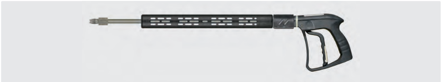
Pistolet vapeur ST-4000 professionnel avec lance en inox, demi-coquilles ST-9 380 mm et buse vapeur basse-pression en inox. Max. 20 bar / 200 °C
