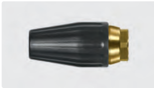
1/4" F. Cône 20°. 100 - 250 bar. Max. 100 °C
