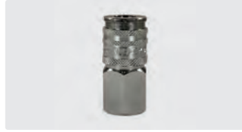
Coupleur femelle : femelle. Laiton / Acier nickelé. Max. 200 bar / 100 °C
