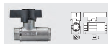
Laiton cadmié. Sphère chromée. Max. 210 bar / 80 °C
