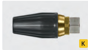
M18 F. Cône 20°. 100 - 250 bar. Max. 100 °C
