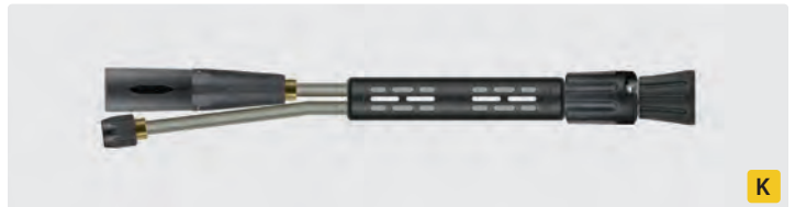
Double-lance mousse avec demi-coquilles ST-9 205 mm, commutateur ST-58, raccord manuel ergonomique, porte-buse pastille livré sans buse et tête mousse ST-75.1 livrée sans buse. Fonctionne en association avec un injecteur produit approprié. Max. 350 bar / 45 l/min / 100 °C
