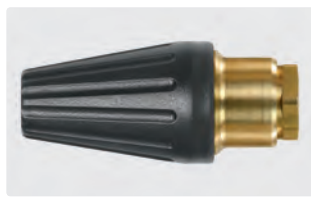
1/4" F. Cône 20°. 120 - 250 bar. Max. 100 °C
