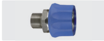
Coupleur surmoulé femelle : mâle. Inox. Cône 60°. Max. 250 bar / 150 °C
