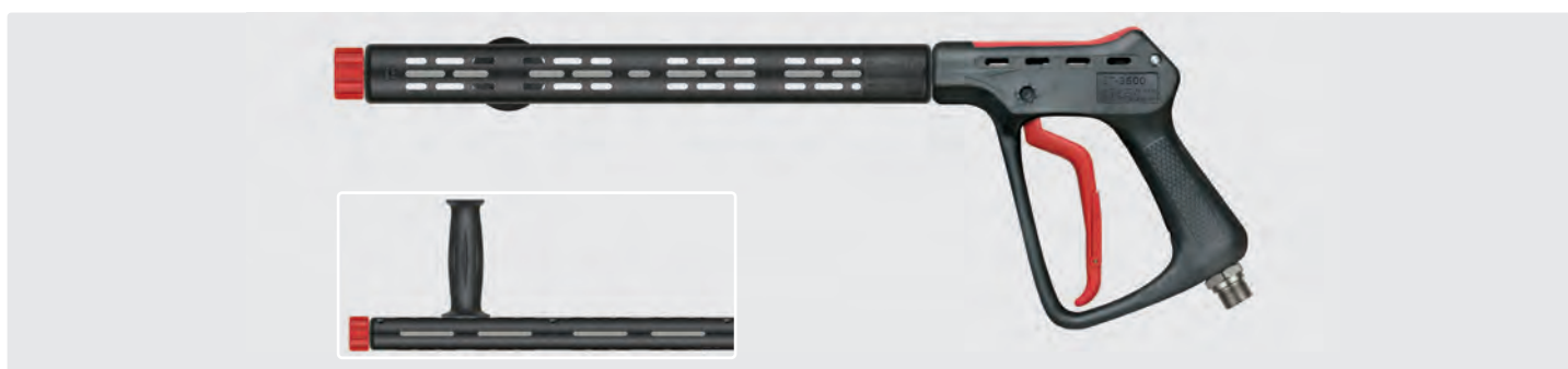
Pistolet THP professionnel avec demi-coquilles ST-9 380 mm, poignée latérale et raccord manuel M22 F. Max. 500 bar / 80 l/min / 150 °C
