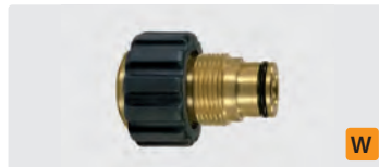
M24 M : 3/8" F. Laiton *. Max. 400 bar
