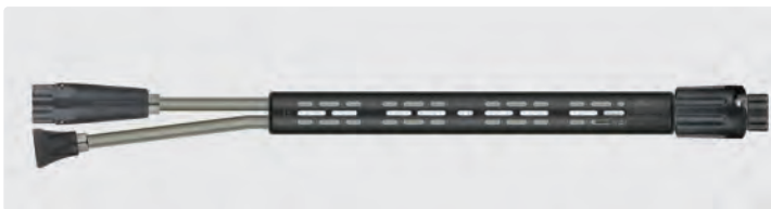
Double-lance mousse avec demi-coquilles ST-9 380 mm, commutateur ST-58, porte-buse ST-10 livré sans buse et tête mousse ST-75 livrée avec buse. Fonctionne en association avec un injecteur produit approprié. Max. 350 bar / 45 l/min / 100 °C
