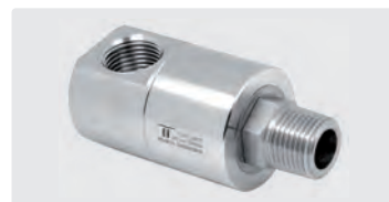
DGEI 90°. Corps en inox. Équipés de 3 roulements à billes. Max. 350 bar
