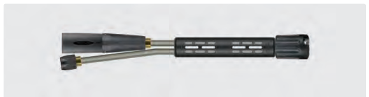
Double-lance mousse avec demi-coquilles ST-9 205 mm, commutateur ST-58, porte-buse pastille livré sans buse et tête mousse ST-75.1 livrée sans buse. Fonctionne en association avec un injecteur produit approprié. Max. 350 bar / 45 l/min / 100 °C
