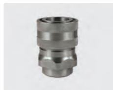
Coupleur femelle : femelle. Inox. Max. 250 bar / 150 °C
