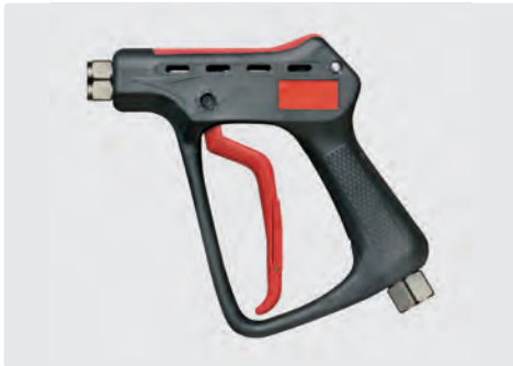
Pistolet THP professionnel. Max. 600 bar / 80 l/min / 150 °C
