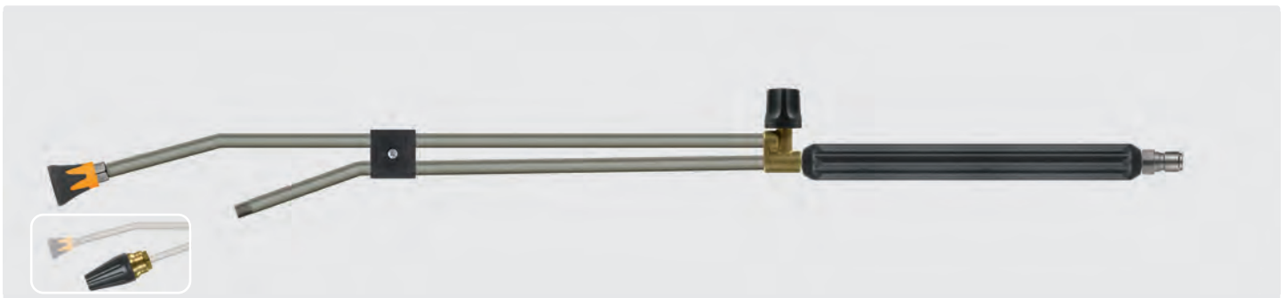
Coupleur ST-3100. Lance surmoulée 300 mm en inox, robinet vertical ST-53, porte-buse ST-10, livrée avec buse basse-pression, tube 1/4" M pour montage rotabuse. Livrée sans rotabuse. Max. 250 bar / 150 °C
