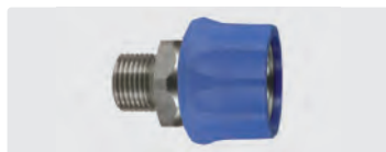
Coupleur surmoulé femelle : mâle. Inox. Cône 60°. Max. 250 bar / 150 °C
