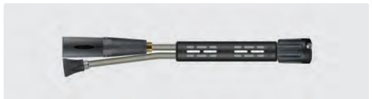
Double-lance mousse avec demi-coquilles ST-9 205 mm, commutateur ST-58, porte-buse ST-10 livré sans buse et tête mousse ST-75.1 livrée sans buse. Fonctionne en association avec un injecteur produit approprié. Max. 350 bar / 45 l/min / 100 °C
