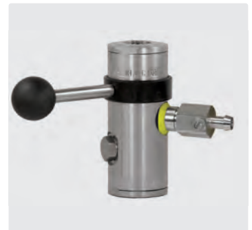
1/2" F : 1/2" F : Cannelé 9 mm. Module injecteur by-pass ST-167 avec vanne de dosage extrême. Max. 350 bar / 100 °C
