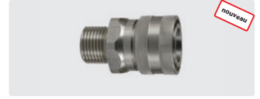
Coupleur femelle : mâle. Inox. Cône 60°. Max. 250 bar / 150 °C
