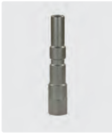
Coupleur mâle KW : 1/4" F. Inox. Six pans 17. Pour lances avec demi-coquilles
