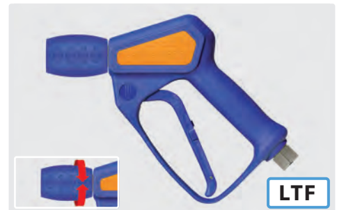
Pistolet professionnel avec raccord rotatif de lance ST-345. Version hors-gel avec clapet. Max. 310 bar / 45 l/min / 150 °C
