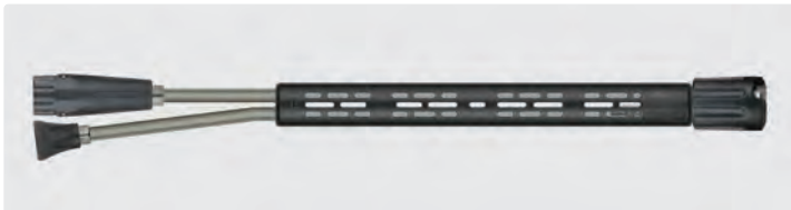
Double-lance mousse avec demi-coquilles ST-9 380 mm, commutateur ST-58, porte-buse ST-10 livré sans buse et tête mousse ST-75 livrée sans buse. Fonctionne en association avec un injecteur produit approprié. Max. 350 bar / 45 l/min / 100 °C
