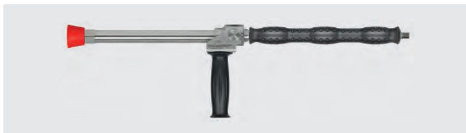
Lance d'hydro-balayage 350 mm inox avec manchon ST-29 Cool & Compact 330 mm, poignée latérale et protège-buse en PVC, livrée sans buse. Max. 280 bar / 130 l/min / 100 °C
