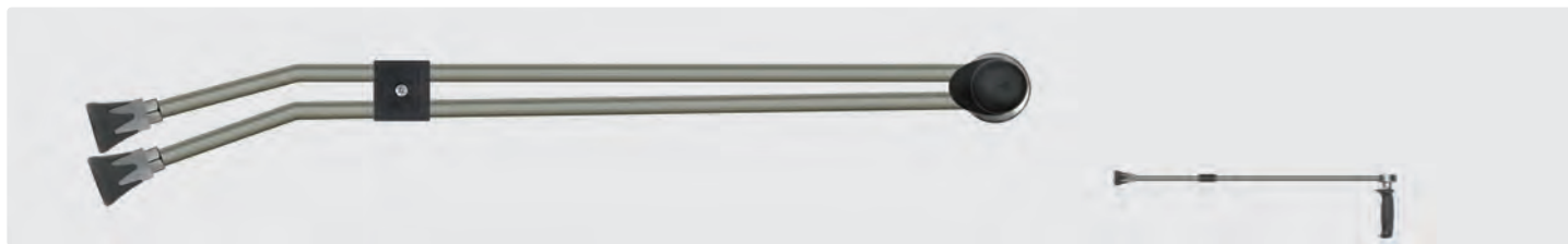
1/4" F. Double-lance tout inox avec robinet latéral ST-54.2 et porte-buses ST-10, livrée avec buse basse pression. Max. 400 bar / 150 °C
