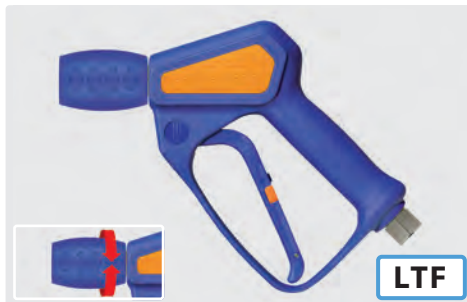
Pistolet professionnel avec raccord rotatif de lance ST-345. Version hors-gel pleumeur. Max. 310 bar / 45 l/min / 150 °C
