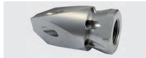
350 bar. 3/8" F. ☒ 55 mm, ☉ = 28 mm, ☒ 0,13 kg. Pour conduites > 50 mm. Jets avant et latéraux avec inserts en inox durci
