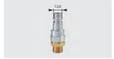
Coupleur mâle : mâle. \varnothing 12 mm. Acier trempé, revêtement mixte nickelé/zingué et laitonné. Max. 200 bar / 100 °C
