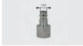
Coupleur mâle : femelle. \varnothing 12 mm. Acier trempé, revêtement mixte nickelé/zingué. Max. 200 bar / 100 °C
