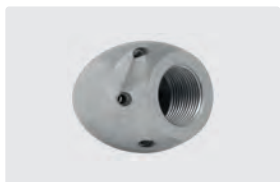
1/2"F. 6x 75° +1x 0°. 30-100 l/min. Pour \varnothing 100-200 mm. \varnothing Extérieur 40 mm. \boxtimes 281 g.
