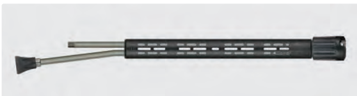
Double-lance mousse avec demi-coquilles ST-9 380 mm, commutateur ST-58, lance avec tube 1/4" M et porte-buse ST-10, livrée sans buse. Max. 350 bar / 45 l/min / 100 °C
