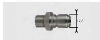
Coupleur mâle : mâle. Inox. Cône 60°. Max. 250 bar / 150 °C
