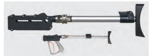
Crosse de pistolet ST-3900. La nouvelle directive UE prescrit l'usage obligatoire d'une crosse de maintien à partir d'une force de recul supérieure à 150 N. Crosse réglable équipée d'un coupleur rapide rotatif. Adaptable sur tous les pistolets THP ST-3600 / ST-3500
