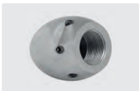
3/4"F. 6x 75° +1x 0°. 30-100 l/min. Pour \varnothing 120-250 mm. \varnothing Extérieur 50 mm. \boxtimes 567 g.
