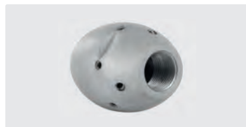
1/2"F. 6x 75° 3x 30° +1x 0°. 80-140 l/min. Pour \varnothing 120-250 mm. \varnothing Extérieur 40 mm. \boxtimes 630 g.
