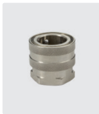
ST-45. Laiton cadmié. Coupleur : 3/4" F. 25 bar / 90° C
