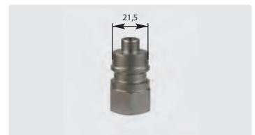
Coupleur mâle : femelle. Inox. Max. 600 bar / 150 °C
