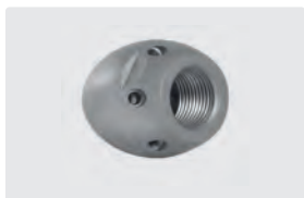
3/8"F. 6x 75° +1x 0°. 25-70 l/min. Pour \varnothing 75-150 mm. \varnothing Extérieur 35 mm. \boxtimes 207 g.
