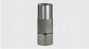
1/4" F : 3/8" F. Inox. Raccord tournant avec roulement radial. Max. 350 bar / 90 °C
